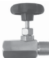
Modelo: 53 Válvula agulha supressora de pulsação com regulagem externa. Regula-se até o ponteiro do manômetro estabilizar-se. Para pressões até 100 kgf/cm 2 .
